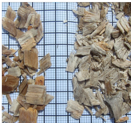
Die Holzstruktur wird während des Pressvorganges aufgebrochen, was Farbe, Homogenität und Festigkeit der Pellets verbessert
