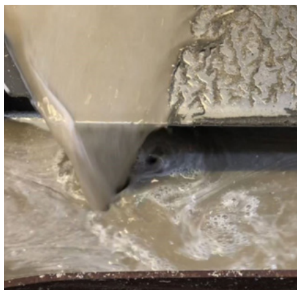
Bis zu 80l/m 3 Wasser fließen während des Pressvorganges ab
